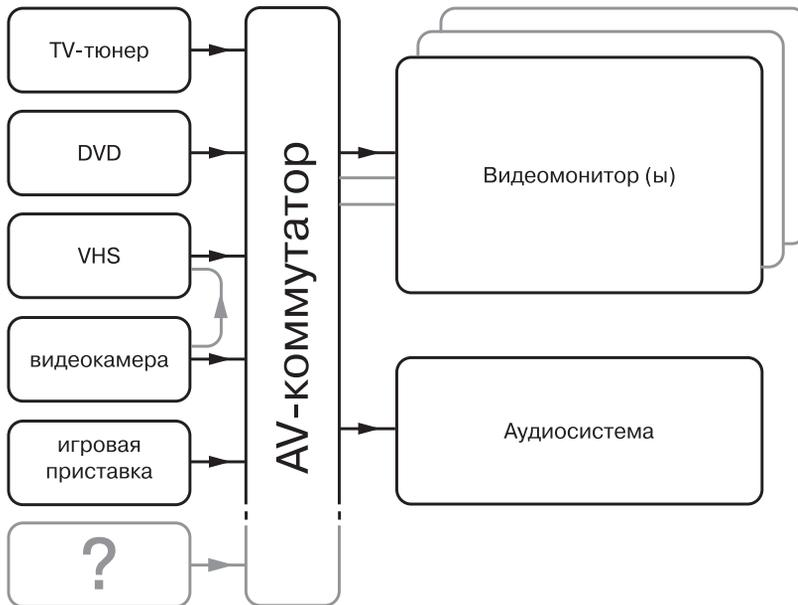
В сложных системах для соединения компонентов в единую сеть используется специальный коммутатор сигналов (AV-мастер), позволяющий подать сигнал с любого источника на любой монитор, что позволяет организовать несколько независимых зон обслуживания. Помимо основной аудиосистемы, для передачи звукового сопровождения могут использоваться беспроводные ИК-наушники или индивидуальные радиоканалы ближнего действия. Многоканальные системы объемного звучания рассмотрены в конце этой главы.
